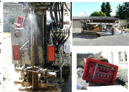
La foreuse et « l'enregistreuse rouge », système informatique embarqué, lors des forages.
